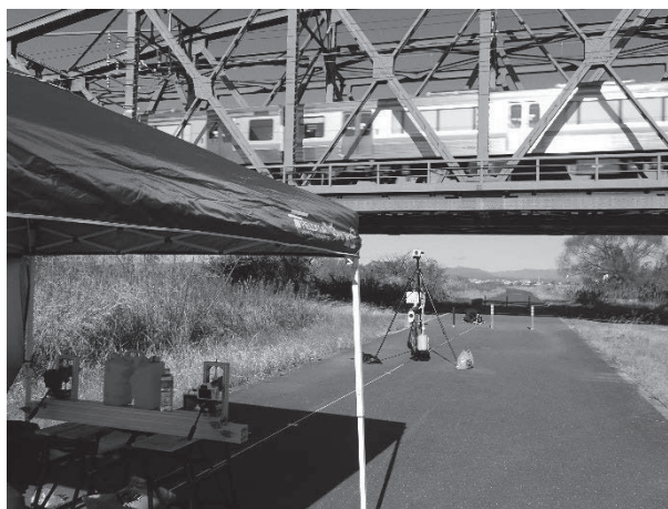
橋梁のたわみ計測の例
