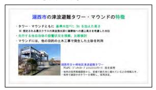
湖西市では想定される最大クラスの津波浸水深に建築物への遡上高さを考慮した基準水位に3mを加えた高さとしておりまして、先行した自治体の設置状況を視察、比較検討の上、仕様を確定させたとのことです。
